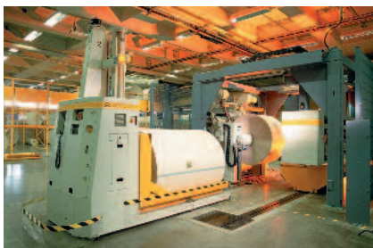
Innerbetriebliche Transportsysteme müssen die höheren Gewichte handhaben können. Wiederum sind aber eine geringere Anzahl erforderlich, da 31 % weniger Rollen zu handhaben sind.
