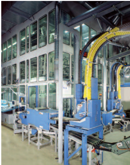
Das Overhead-Transportsystem Newsveyor kann gleichzeitig bis zu drei Schuppenströme und damit eine große Zahl gedruckter Exemplare pro laufendem Meter transportieren. Diese Anlagen sind kostengünstiger als Einzelgreifersysteme.
