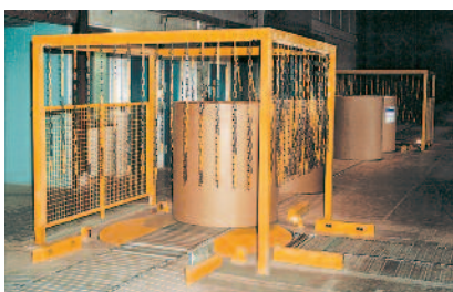
Förderbänder müssen auf die höheren Gewichte und größeren Breiten ausgelegt sein. Kurven benötigen mehr Platz.
