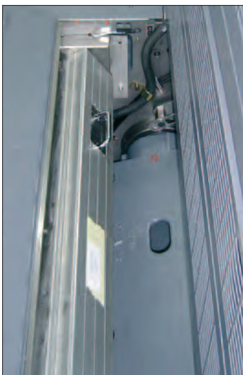
Secador UV entre cuerpos impresores en una máquina Roland 700.
