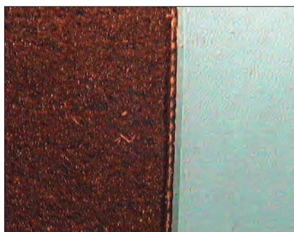
Superficie de cauchos despegables: la cara superior de impresión y el área negra que no se imprime son evidentes. Foto: Trelleborg.
