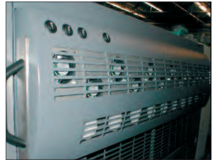
Dispositivo de soplado combinado con un sistema de extracción de nubes de tinta. Fuente: manroland.
