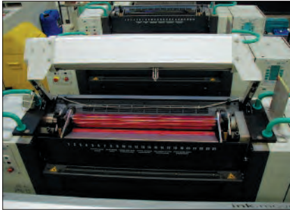
Cubierta de tinta abierta para mostrar el agitador en el tintero, que evita que la tinta UV de alto tiro se estacione en los conductos.
